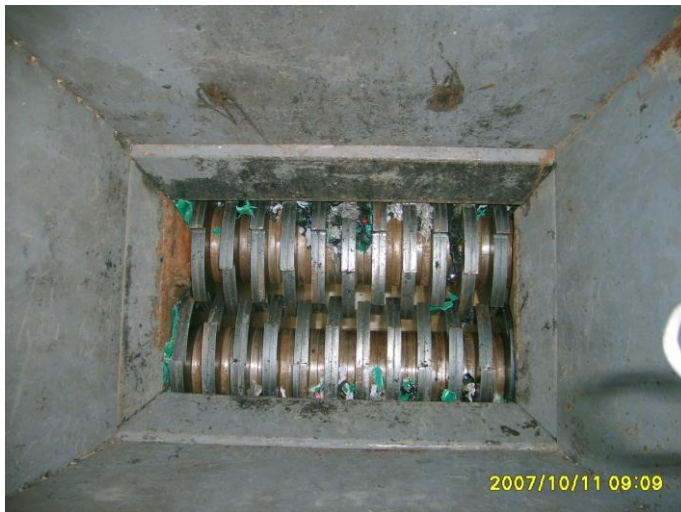
Kísérleti forgótárcsás nyíró- aprítógép (Terra center)
